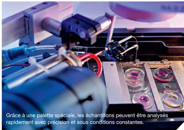
Grâce à une palette spéciale, les échantillons peuvent être analysés rapidement avec précision et sous conditions constantes.
